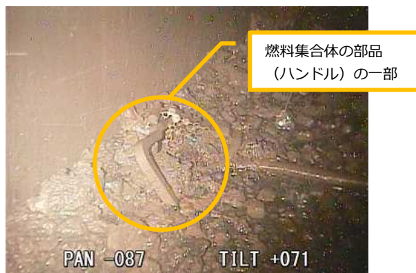
確認された炉内構造物
